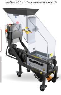
des machines surmesure. Il est ainsi Goliath Plus 3, composé de 3 grands couteaux et 4 rouleaux dentés assemblés sur un arbre rotatif (chaque dent créée un granulé).
